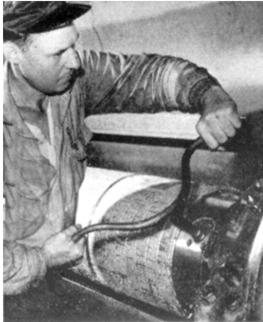
Ilustración 47: Un empleado de la R.R. Donnelley & Sons atornilla una plancha de impresión a un cilindro de la prensa (Fotografía tomada de la World Book Encyclopedia de 1958).
