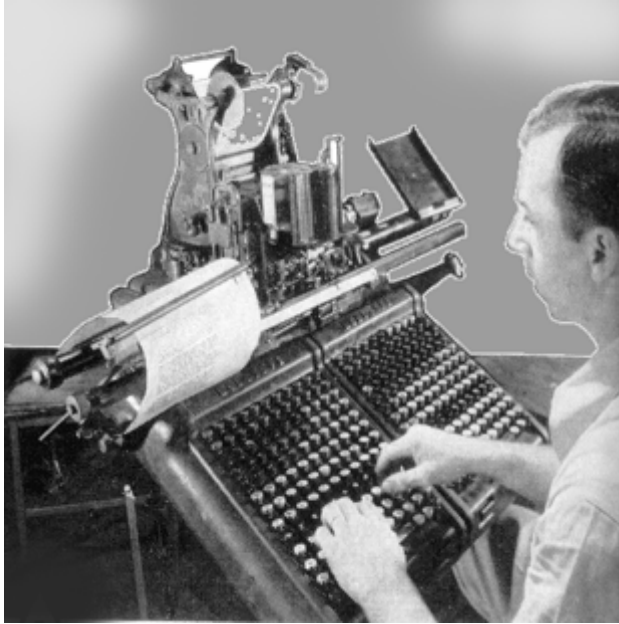
Ilustración 21: Un operador de monotipo de R. R. Donnelley & Sons efectuando la composición de un texto ( World Book Encyclopedia , 1958).
